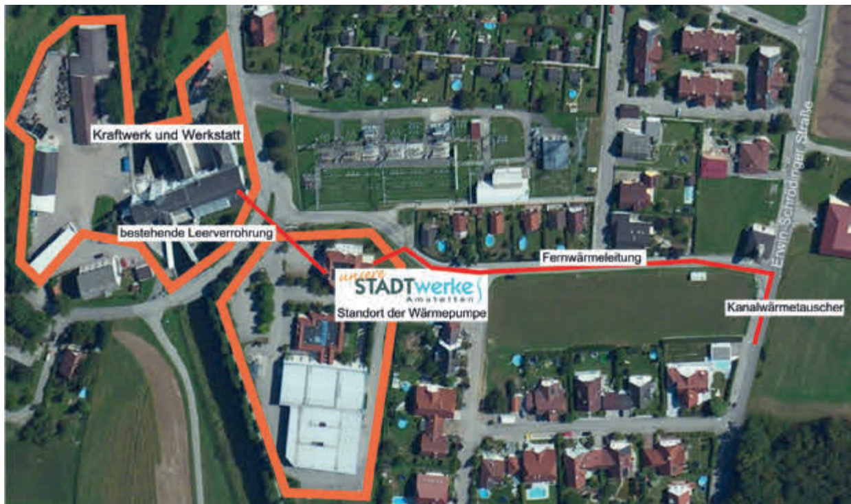
Abb. 11: Amstetten, ein Projekt zur Wärmenutzung aus dem Kanal mit Vorzeigecharakter, da es auch wirtschaftlich rentabel ist
