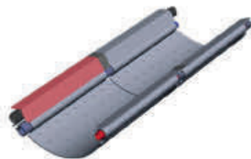
Abb. 3: Moderne Wärmetauscher (Thermliner Form B Prinzipdarstellung) können auf die Sohle eines bestehenden Kanals montiert werden und dem Abwasser Wärme entziehen.
