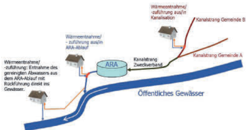
Abb. 1: Schematische Darstellung von Wärmeentnahmen und -einträgen
